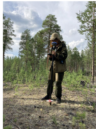
Определение опорной точки при помощи ГНСС-приемника
